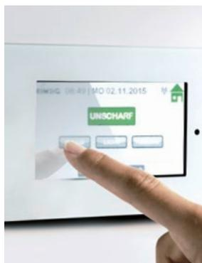
Les fonctionnalités de fenêtre les plus variées sont contrôlables en tout confort sur l'écran tactile, auquel s'ajoute la surveillance par une installation d'alarme 4B. Vous identifiez en un coup d'œil les fenêtres et portes ouvertes, en battant, en imposte ou fermées. Un contact du doigt suffit pour définir si une alarme doit être déclenchée ou non par l'ouverture. Plusieurs éléments de commande peuvent être raccordés sur demande.
