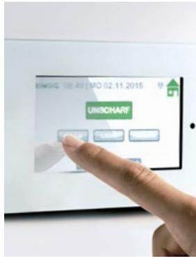
Über das Bedienelement mit Touch-Display lassen sich die unterschiedlichen Fenster-Funktionen bequem steuern, nicht zuletzt auch die Überwachung mittels Alarmanlage von 4B. Auf einen Blick erkennen Sie, welche Fenster und Türen geöffnet, gekippt oder geschlossen sind. Mit einem Fingertipp bestimmen Sie, ob bei einem Öffnen Alarm ausgelöst werden soll oder nicht. Auf Wunsch können mehrere Bedienelemente angeschlossen werden.
