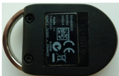
Image 9 : Desserrer les vis et retirer le couvercle
